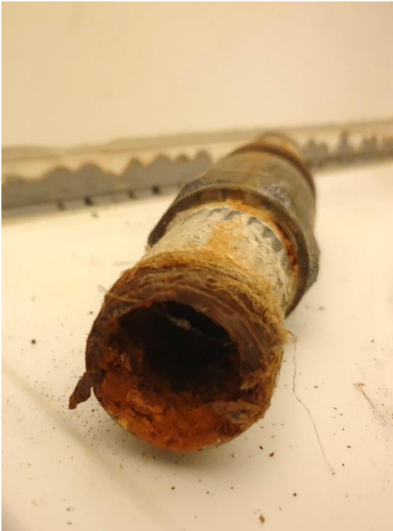
Udskåret rørstykke, der lå i badeværelsesskakten i en bolig, ved gennemgangen. Tydelige tegn på korrosion.
