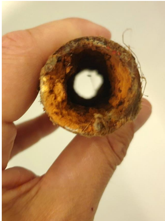
Udskåret rørstykke, der lå i badeværelsesskakten i en bolig, ved gennemgangen. Tydelige tegn på korrosion.
